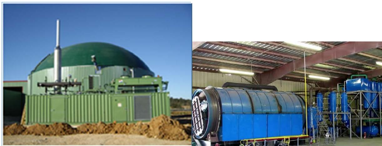
**Figura 14.** Digestor anaerobio y planta de pirolisis
