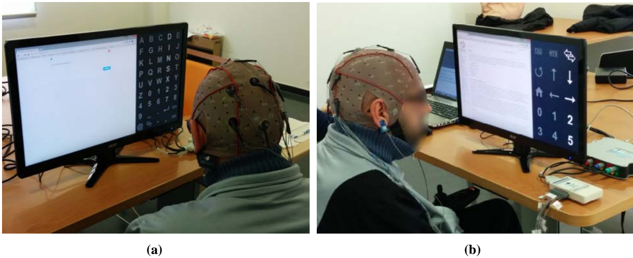
Figura 5. Pacientes de esclerosis múltiple utilizando la aplicación de navegación Web adaptada controlada mediante BCI durante las sesiones de evaluación de la herramienta: (a) Se observa al usuario escribiendo un texto en un campo de formulario que será enviado a través de la herramienta Web de mensajería instantánea Twitter. Es posible observar que el sistema de navegación Web propuesto no invade ni modifica los contenidos visualizados por el usuario, dando como resultado una experiencia de navegación más real y cómoda. A la derecha de la pantalla, se observa la matriz de teclado con la cuarta columna iluminada (estímulo de generación del potencial evocado P300 de acuerdo al paradigma oddball ). (b) Se observa al usuario consultando información en la Web Wikipedia, independientemente de la presentación de estímulos en la matriz P300 de navegación, de acuerdo al sistema de umbralización de la respuesta evocada implementado en la herramienta. Mientras, a la derecha de la pantalla, se observa la matriz de navegación con la tercera columna iluminada.
