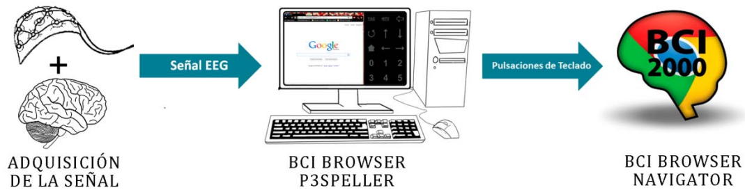
Figura 1. Estructura principal de la aplicación de navegación web desarrollada.
